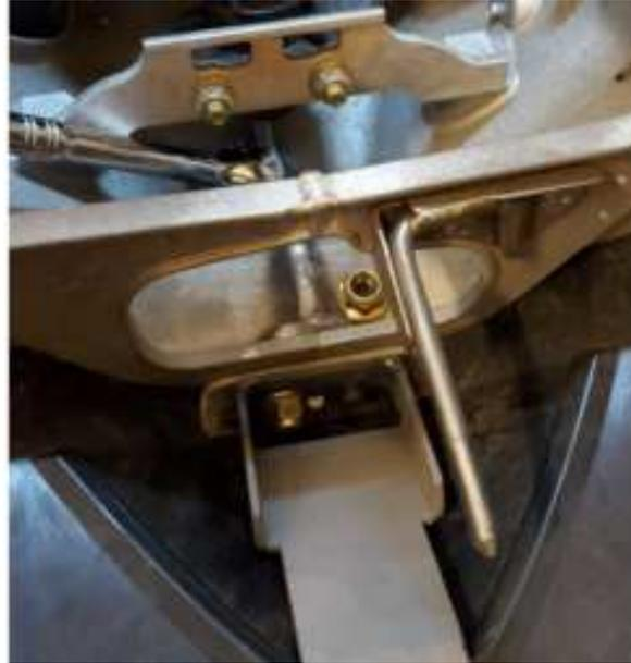
Dévisser les écrous et boulons comme sur la photo de gauche. Installer le renfort en acier (gris sur la photo) et revisser les boulons et écrous
