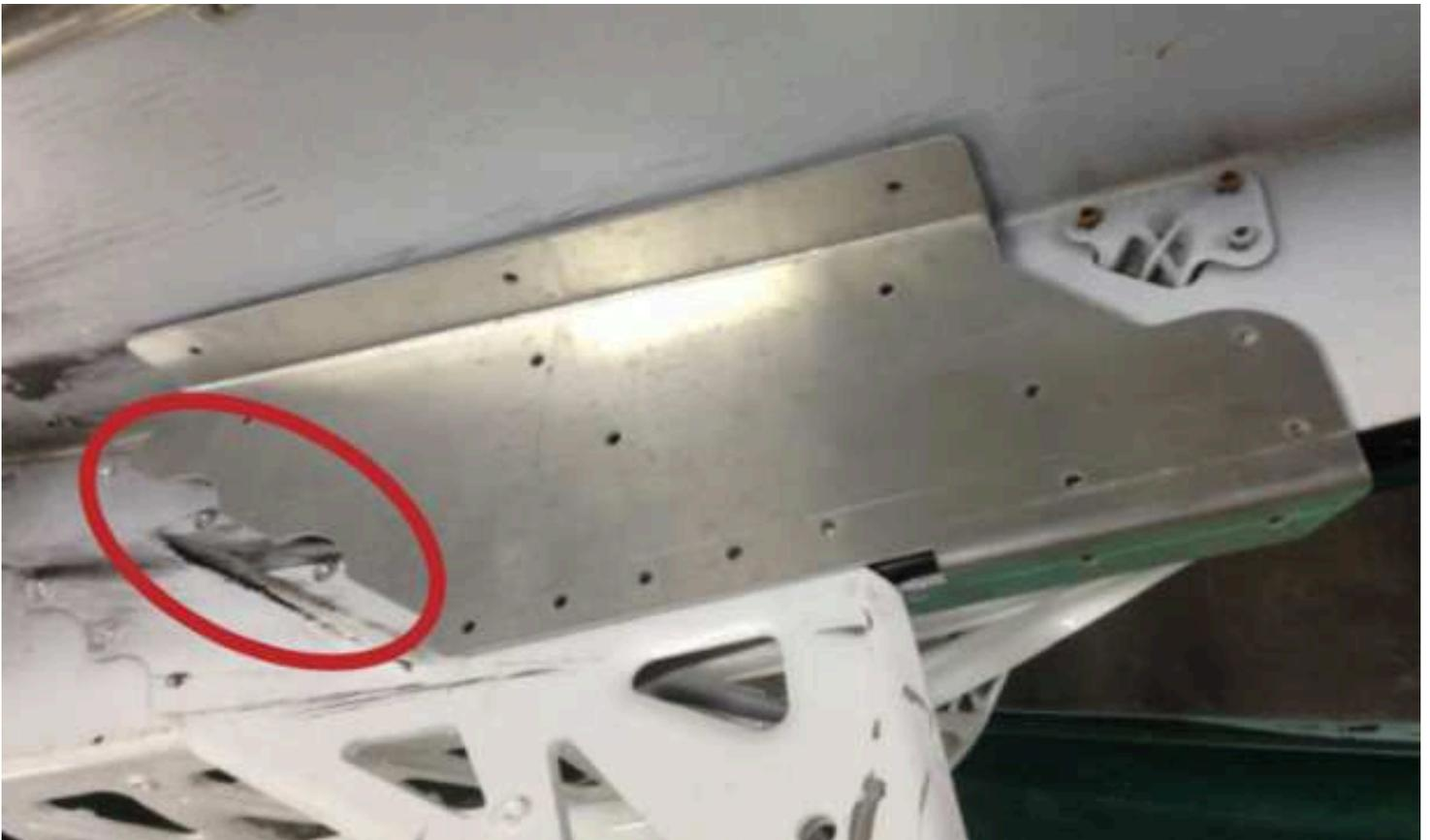
Installer la plaque de renfort en utilisant les trous des 3 étapes précédentes. Percer les autres trous et fixer avec les rivets de stainless.
