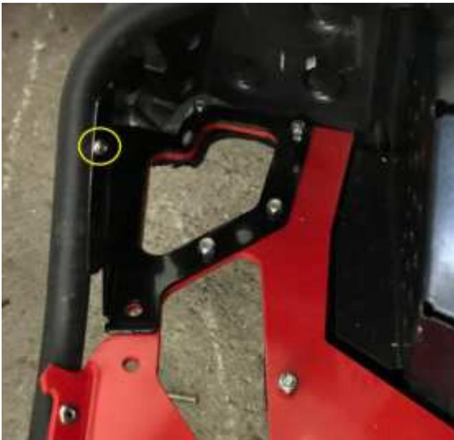
Fixer les garde-neige avec les boulons existants. Ajouter un boulon sur le tube latéral (voir photo). Utiliser un boulon court et faire des filets 10-32 dans le tube.
