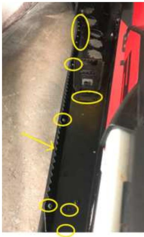
Enlever les rivets fixant le tube latéral au marche pied, le repose pied pour passager et le tube latéral. (Pour enlever le tube latéral, enlever les bolts à chaque extrémité après avoir enlever les rivets indiqués sur la photo).
