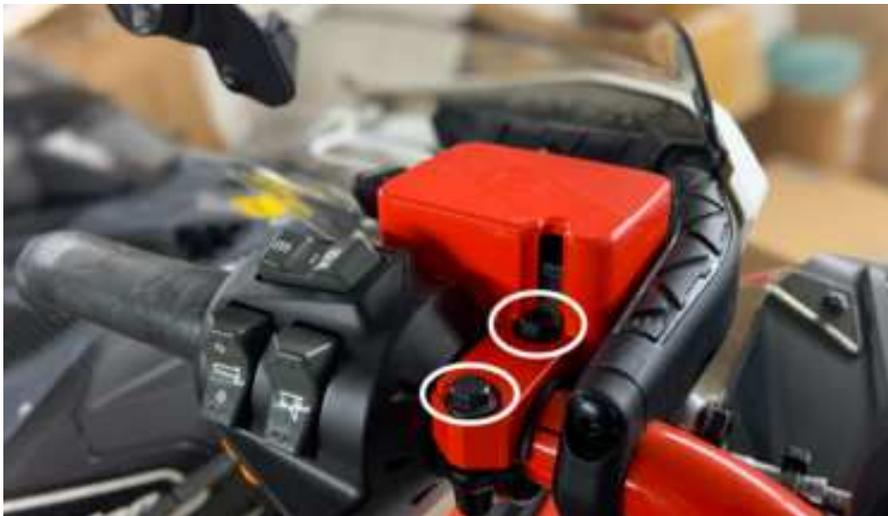
Installer le protecteur en utilisant les 2 boulons d'origines. Serrer à la tension désirée.
