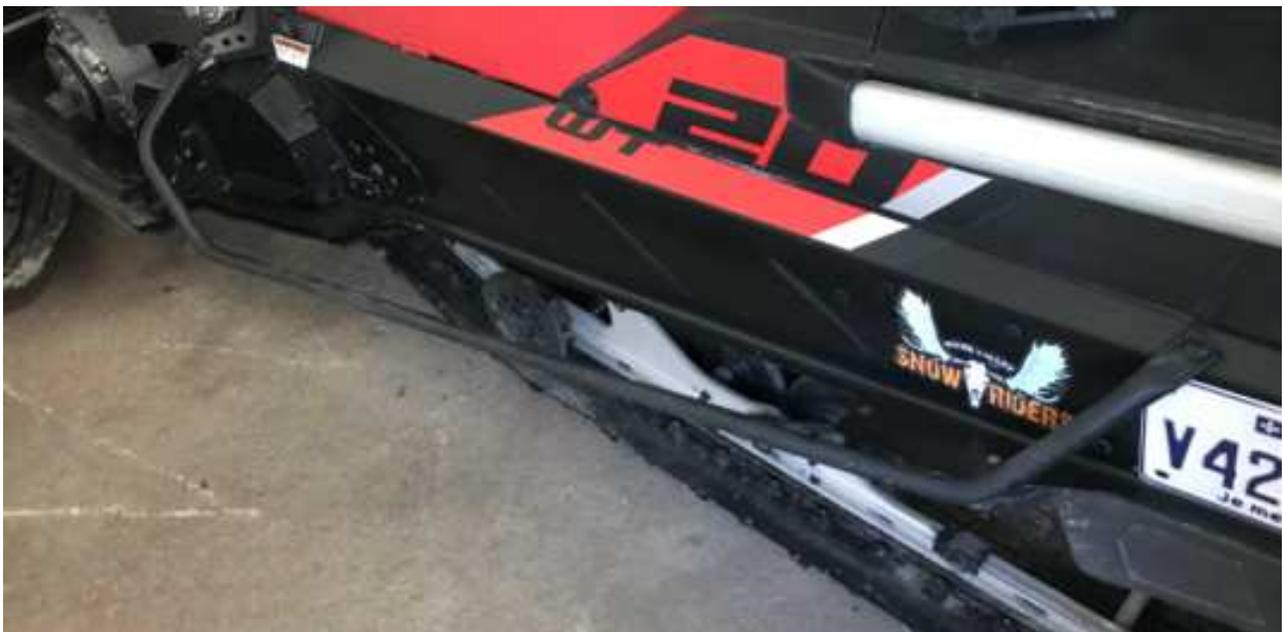
Positionner le marche pieds. Riveter le tube latéral au marche pieds Percer les 3 trous sur le côté du tunnel
