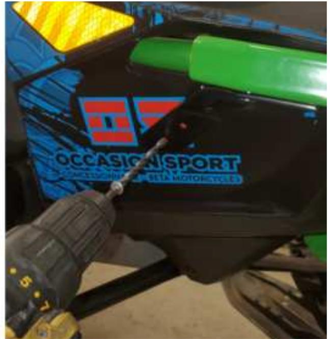
Positionner le déflecteur de débris, marquer et percer le pare-chocs. Ensuite, riveter le déflecteur au pare-chocs ce qui le maintiendra en place et facilitera le perçage et rivetage au plastique de la motoneige.
