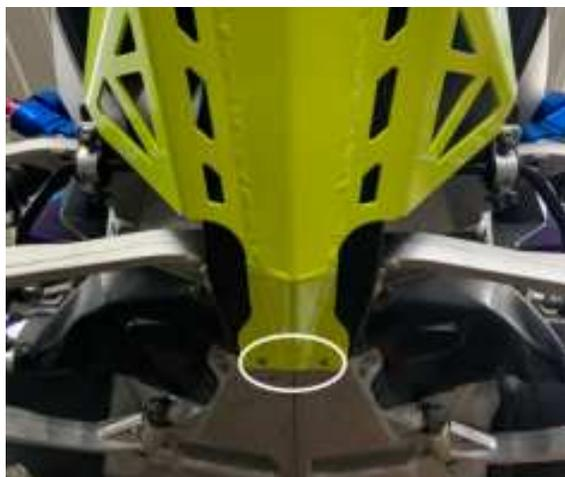
Enlever les rivets d'origine illustrés sur la photo ci-gauche. Fixer la partie en dessous de la motoneige à l'aide des rivets fournis à l'endroit indiqué sur la photo ci- gauche.
