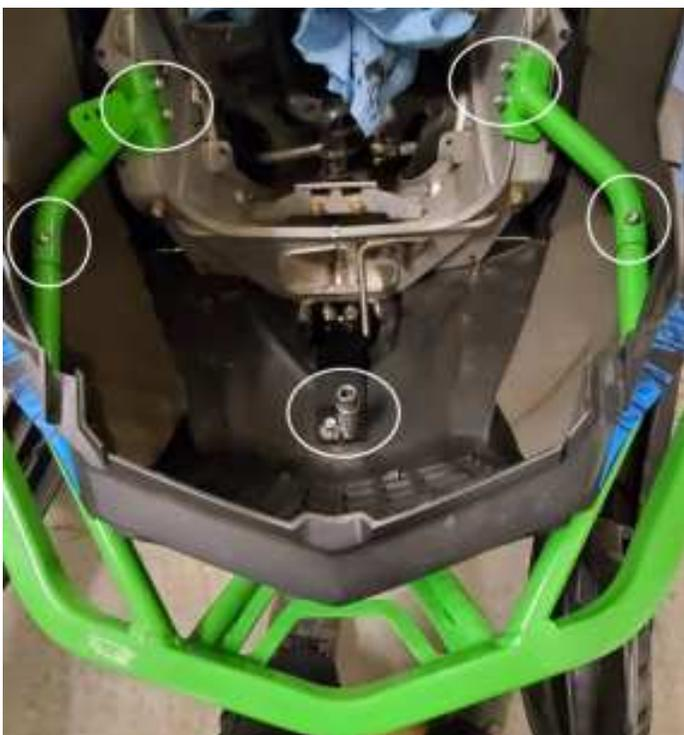
Insérer le devant du pare-chocs dans les plastiques de la motoneige par le devant et ensuite fixer avec les boulons et écrous inclus aux endroits indiqués sur la photo. Serrer tous les boulons et écrous
